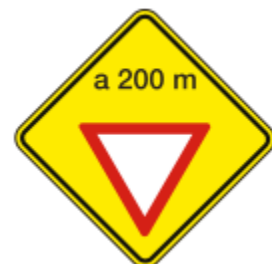
P.33 (b) PROXIMIDAD DE SEÑAL RESTRICTIVA (paso)
