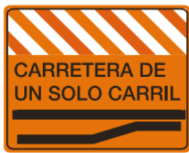
T.3 CARRETERA DE UN SOLO CARRIL
