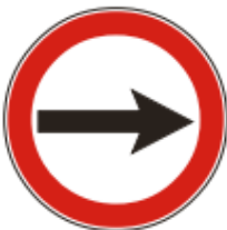
R.21(a). SENTIDO DE CIRCULACIÓN (DERECHA)
