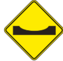
P.11.(b) PERFIL IRREGULAR (badén)
