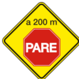
P.33 (a) PROXIMIDAD DE SEÑAL RESTRICTIVA (pare)
